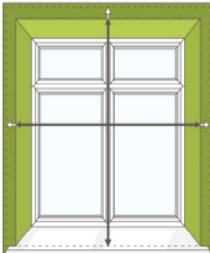
Mesurer la largeur et la hauteur totales de la surface à couvrir
